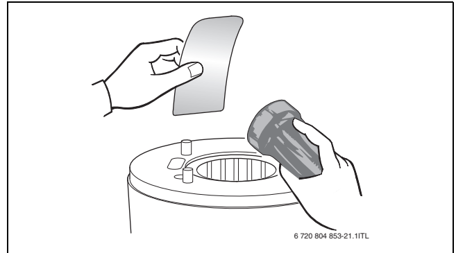
Res. 51 Isı bloğunun atık bakımından kontrolü
