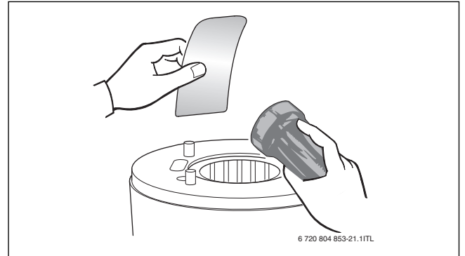
Res. 45 Yanma gövdesinin atık bakımından kontrolü
