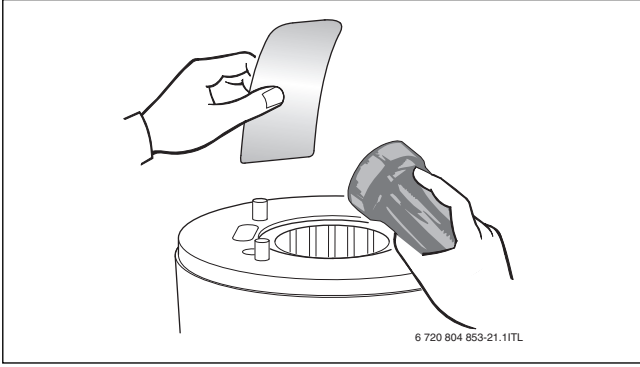
Res. 60 Isı bloğunun atık bakımından kontrolü
