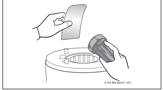
Res. 50 Isı bloğunun atık bakımından kontrolü
